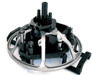
Vorrichtung zur Maßkontrolle von Lenkrädern für die Automobilindustrie.
